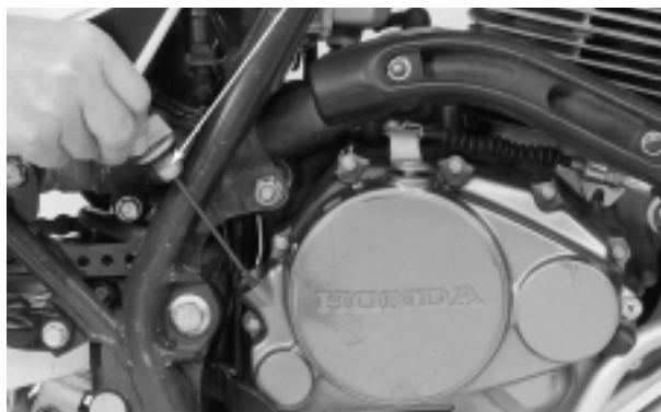
MEDIDOR DO NÍVEL DE ÓLEO
