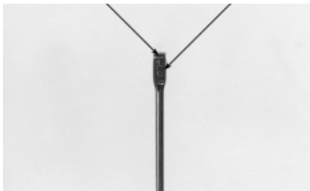
NÍVEL INFERIOR MEDIDOR DO NÍVEL DE ÓLEO
