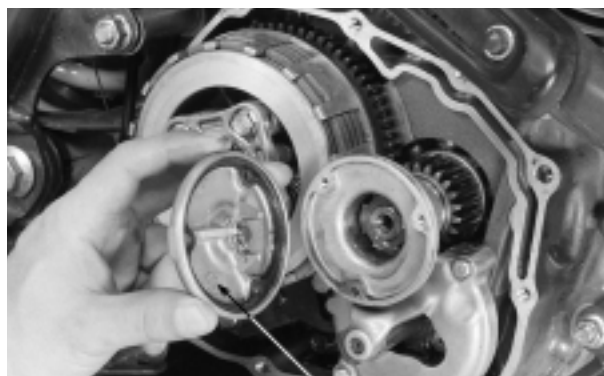
TAMPA DO ROTOR DO FILTRO
