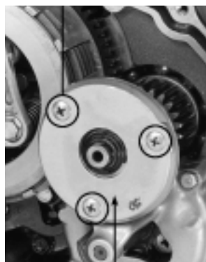
TAMPA DO ROTOR DO FILTRO
